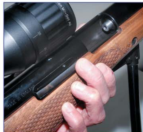
De vrijgave-pal van de anti-beartrap inrichting. Air Arms geeft ruiterlijk toe dat het ding aan de andere kant hoort te zitten.
